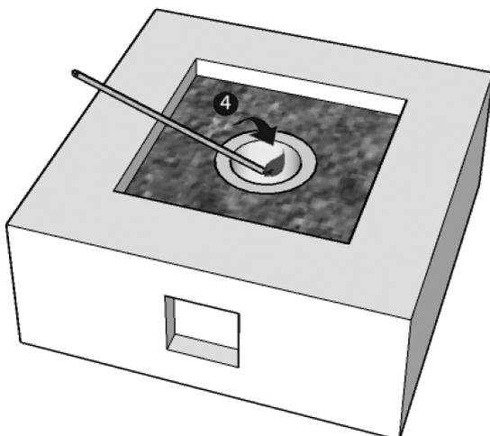
Sumerja la varilla encendida en la zona del quemador para encender contiene combustible.
