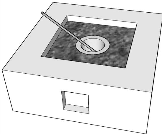
Sumerja la punta del encendedor en la abertura de la cámara «zona del quemador» para mojar el extremo.
